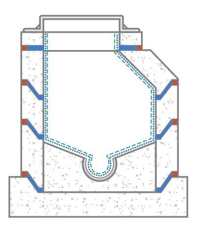
•••• CONCENTRATE SLURRY COAT CONCENTRATE DRY-PAC --- MODIFIED SLURRY COAT PATCH'N PLUG
